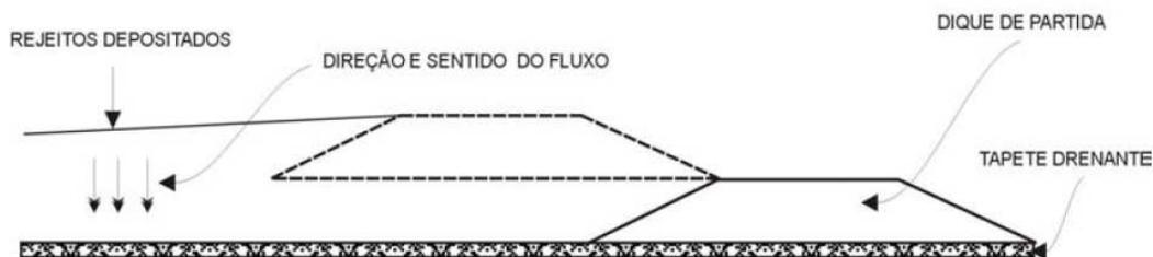
Figura 2- Concepção de fluxo gravitacional em uma pilha de rejeitos
