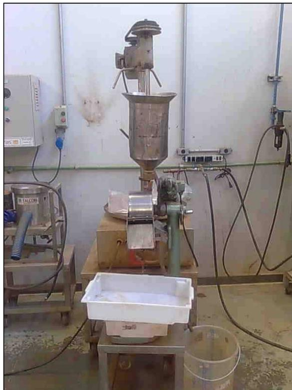
Figura 20- LIMS - Separador magnético via úmida de baixa intensidade.
