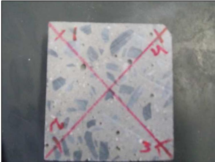
Figura 34 – Definição dos pontos de monitoramento da amostra
