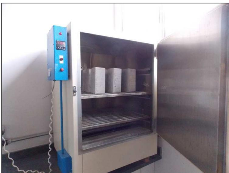
Figura 31– Secagem dos corpos de prova em estufa
