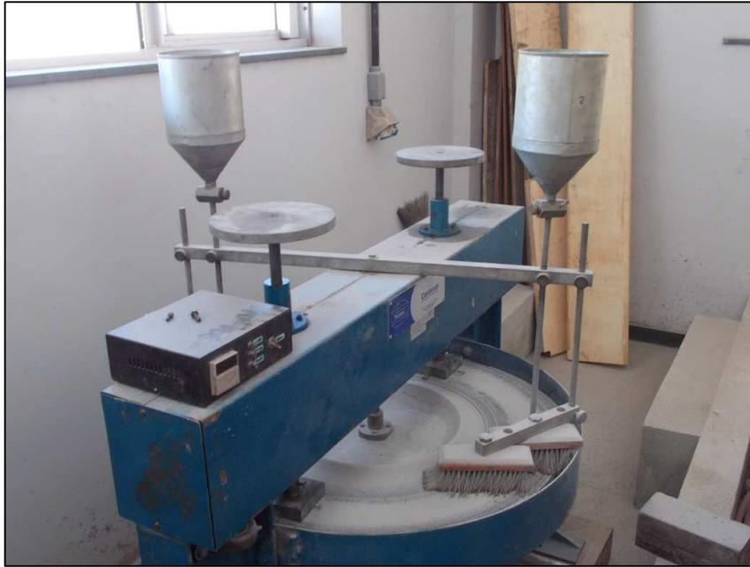
Figura 32 – Abrazímetro utilizado no ensaio de abrasão
