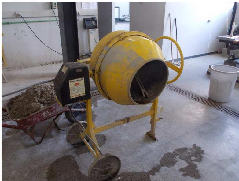
Figura 24 – Betoneira utilizada na confecção do concreto.
