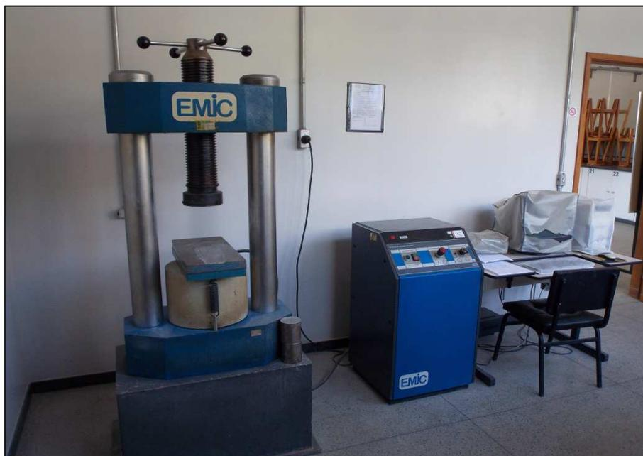
Figura 29 – Prensa hidráulica utilizada no ensaio de compressão.
