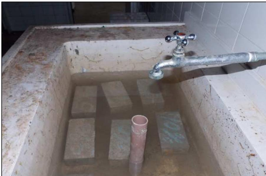
Figura 28- Corpos de prova imersos em tanque com água
