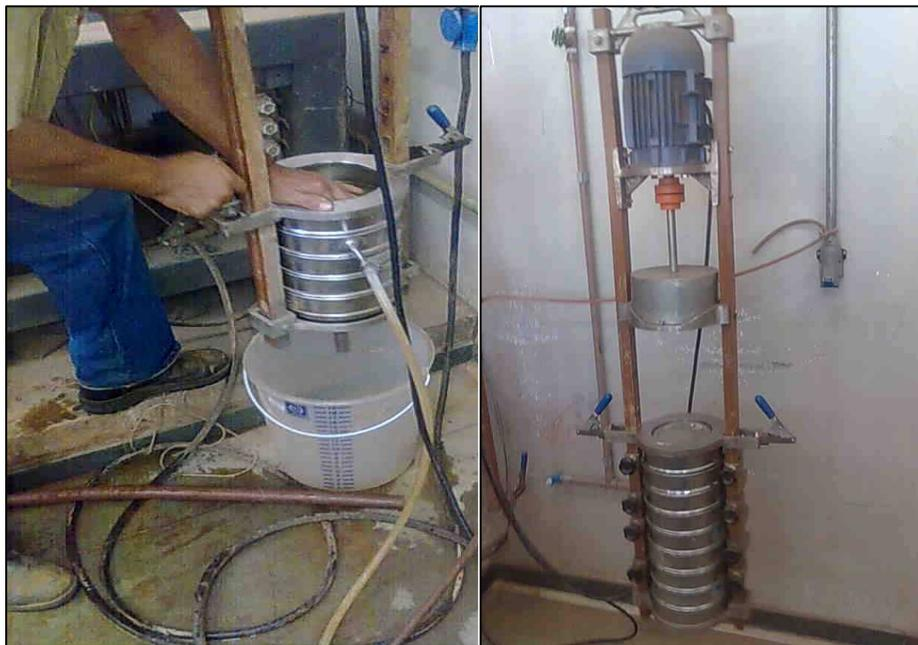
Figura 17- Peneiramento a úmido    Figura 18- Peneiramento a seco
