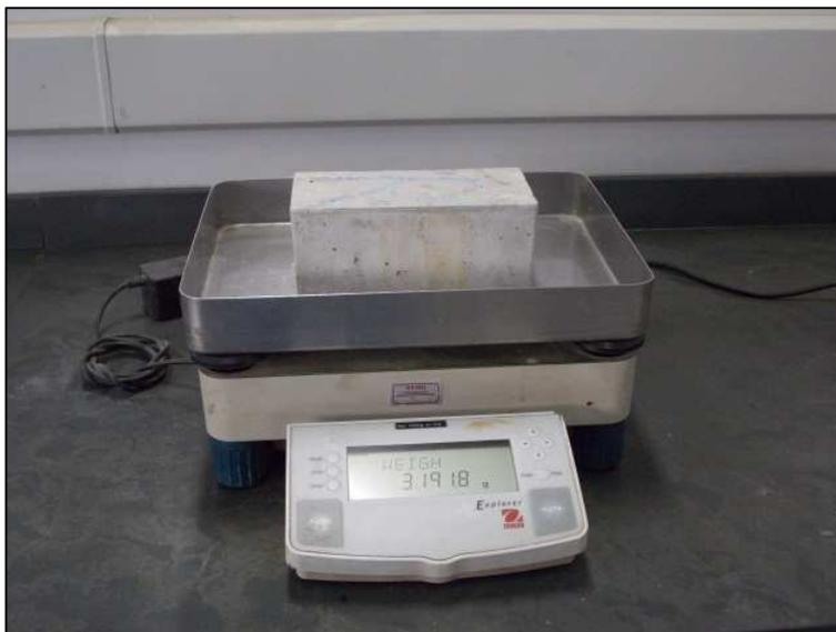
Figura 30– Pesagem de corpo de prova
