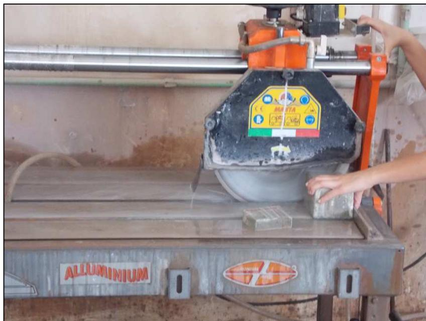
Figura 33– Serra circular utilizado no corte dos corpos de prova
