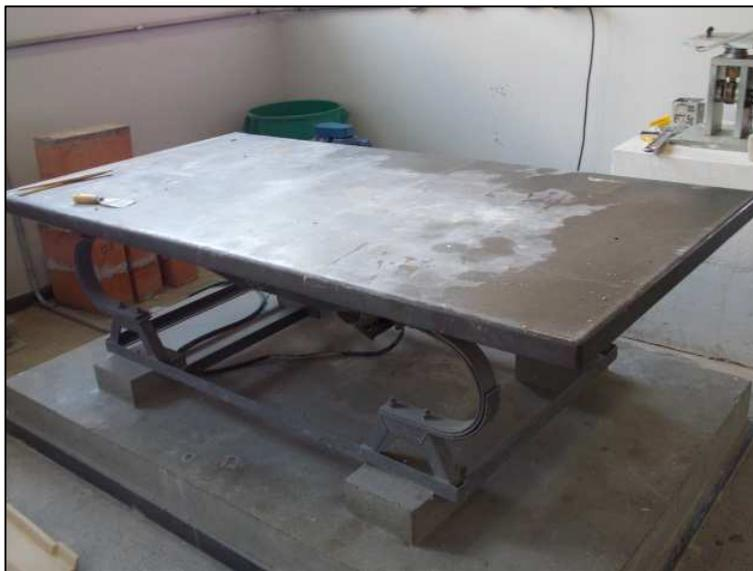
Figura 26 – Mesa vibratória utilizada no adensamento dos concretos
