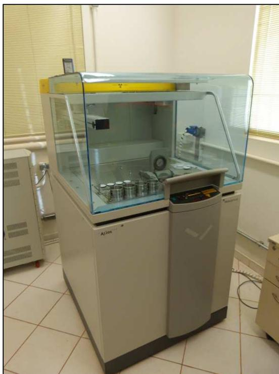
Figura 22- Espectrômetro de fluorescência de raios – X
