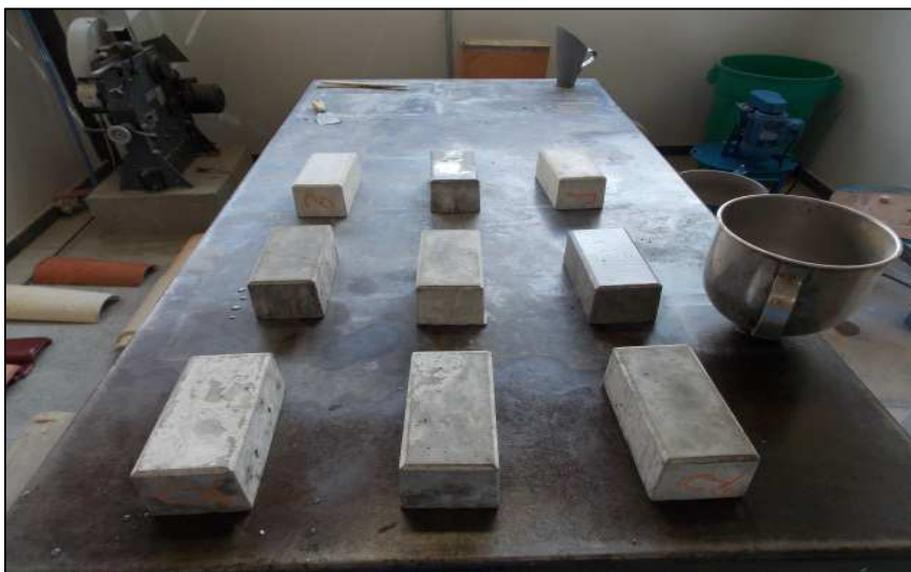
Figura 27- Corpos de prova capeados com pasta de cimento
