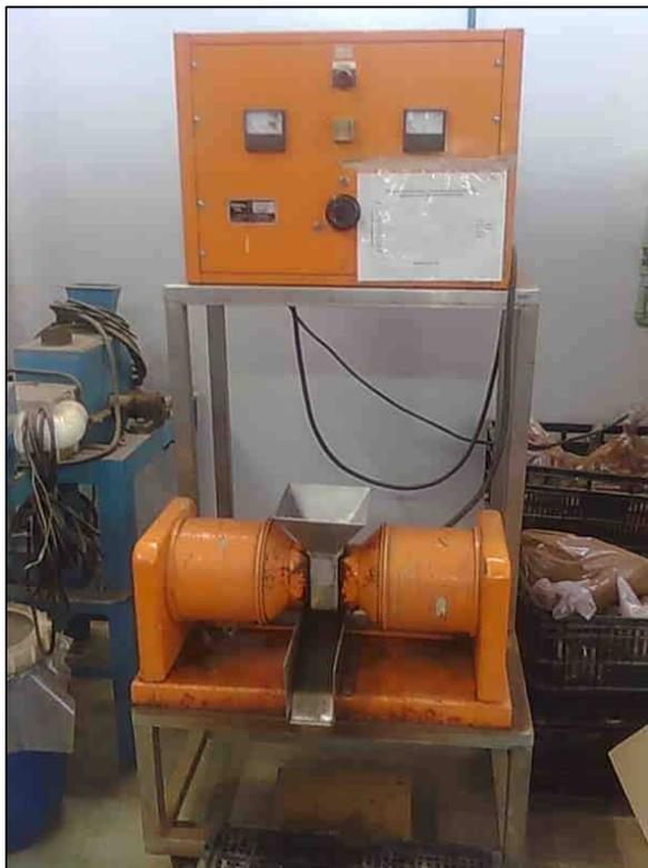
Figura 21 - WHIMS - Separador magnético via úmida de alta intensidade.
