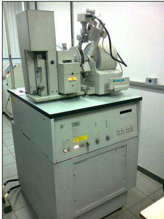
Figura 23- Difratorômetro de Raios-X
